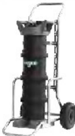
Het water stroomt door ionen-uitwisselingshars, die de vaste stoffen bindt. Daarmee wordt ultrazuiver water gegenereerd, dat identiek is met gedestilleerd water. Deionisatie verwijdt 100% van de mineralen en genereert daarmee een hoge waterkwaliteit. Filter met een relatief voordeelige startinvestering. Al het gefilterde water kan gebruikt worden. Mobiel voor direct gebruik ter plekke.
