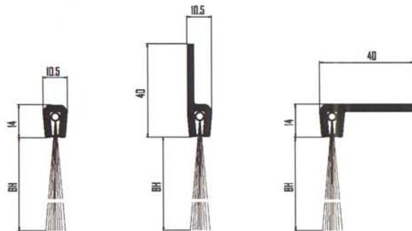
Unsere **flexiblen Streifen- und Abdichtbürsten** bieten wir an in drei Grundprofilen an: Mit senkrechtem oder waagrechtem Flansch und ohne Flansch. **Der Bürstenbesatz ist lückenlos dicht.**
